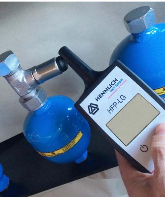
Das HFP-LG System ist eine komfortable Möglichkeit zur Überwachung des Vorfülldruckes in Druckspeichern.
